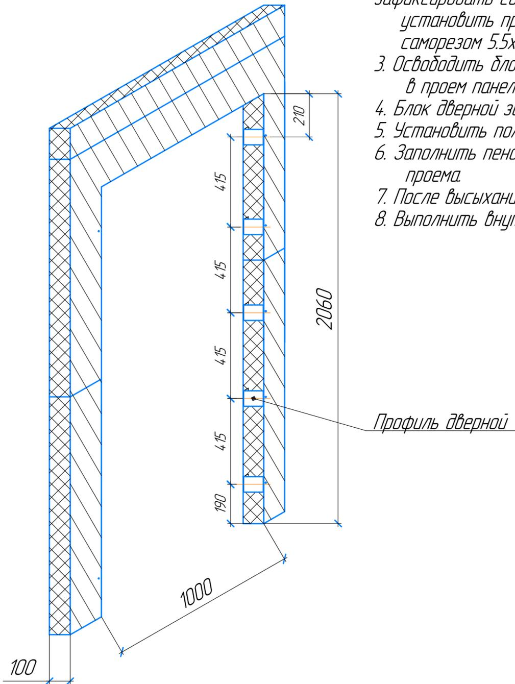
1. В панели стеновой отметить контур проема под дверь согласно планировочному решению. Проем должен быть на 10мм шире габаритов двери с каждой стороны.
